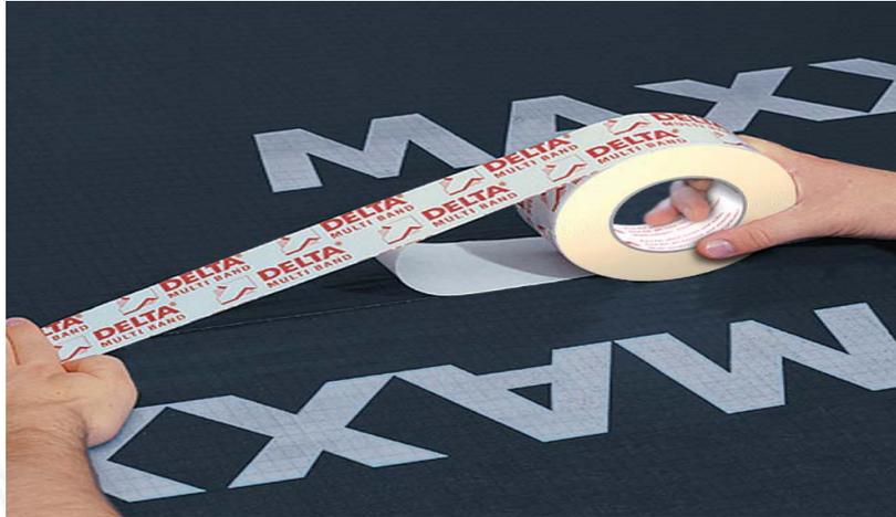
**Description:** ruban collant pour le collage des recouvrements et la réparation des écrans DELTA®. Collage sur la face externe des écrans (face avec impression du nom du produit). Applications extérieures et intérieures. Possibilité de collage des joints entre panneaux OSB ou fibres de bois (avec colle primaire DELTA®-PREN)
